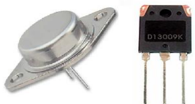
Hình 1.8. Hình dạng thực tế một số loại Transistor
