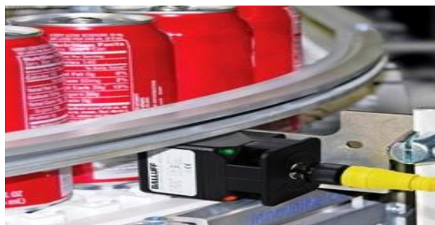
Hình 9.4. Ứng dụng cảm biến tiệm cận điện cảm
