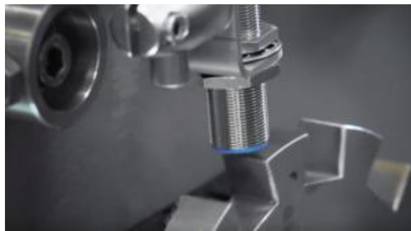
Hình 9.6. Ứng dụng cảm biến tiệm cận điện cảm
