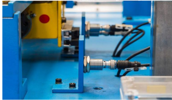
Hình 9.5. Ứng dụng cảm biến tiệm cận điện cảm
