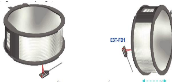
Hình 10.3. Ứng dụng cảm biến quang phản xạ khuếch tán
