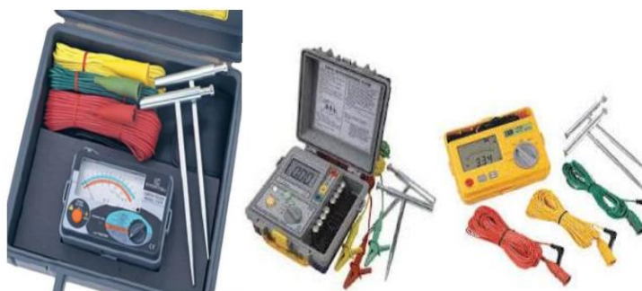
Hình 5.5. Ôm kế đo điện trở nối đất
