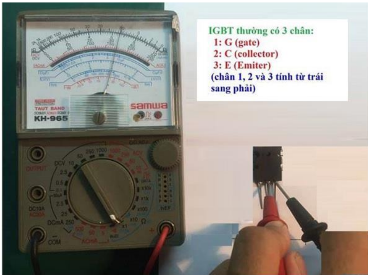
Hình 3.29. Cách đo và kiểm tra IGBT bằng đồng hồ vạn năng
