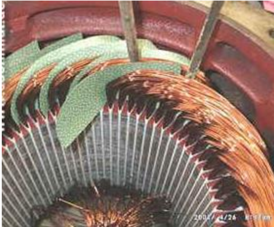
Hình 3-22: Tách rời phần đầu nối của các tổ bối dây, lót bì cách điện
