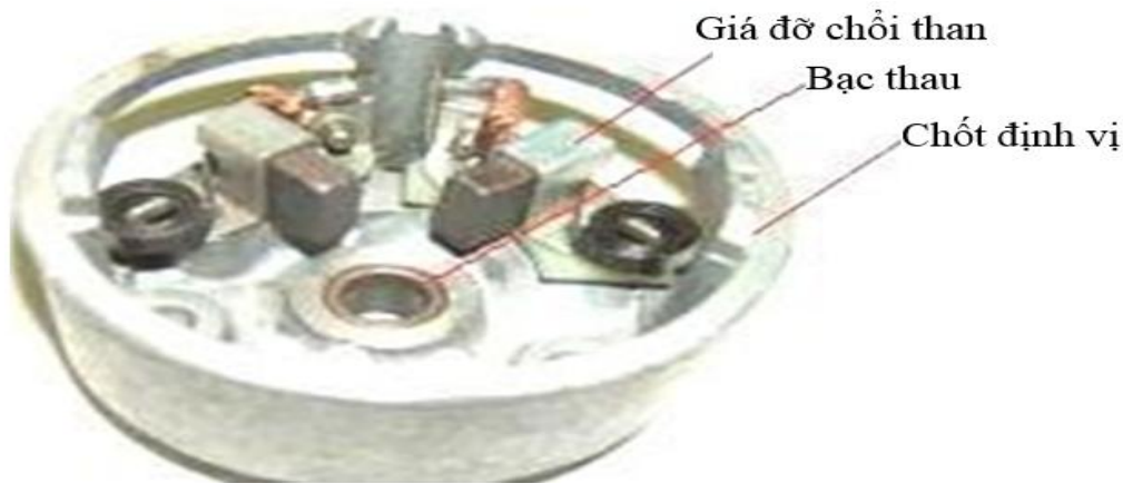
Hình 3-4 : Nắp và giá đỡ chổi than.
