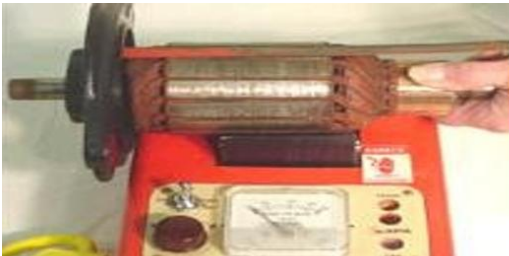
Hình 3-13: Kiểm tra ngắn mạch cuộn dây phản ứng dùng rô nha ngoài.
