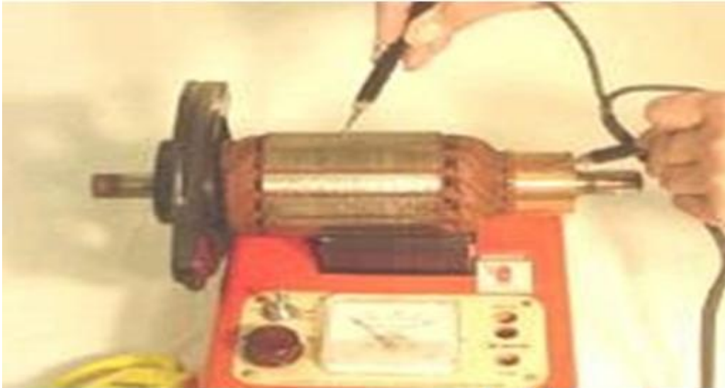
Hình 3-16: Kiểm tra cách điện giữa cổ góp và rôto
