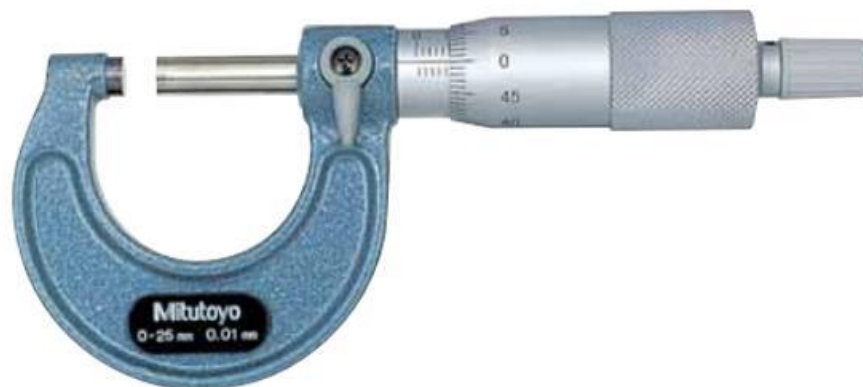
Hình 2.16: Cấu tạo panme
