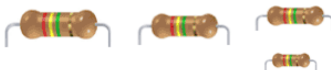
Hình 2.5. Các điện trở : 2W - 1W - 0,5W - 0,25W
