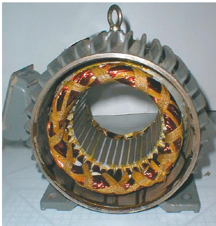
Hình 3-23: Phần đầu dây sau khi băng bó
