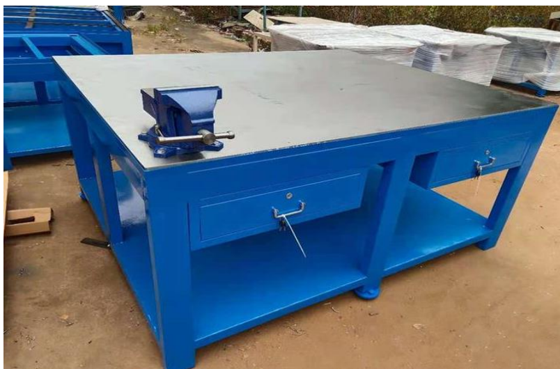
Hình 1.2: Bàn thực hành gia công đường ống
