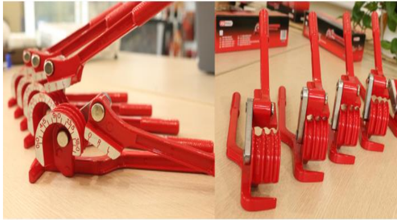
Hình 2.7 Dụng cụ uốn ống bằng tay
