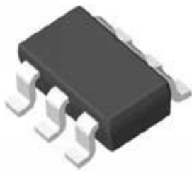
Hình 3.17 . Hình dáng và cấu trúc các chân IC AD7414
