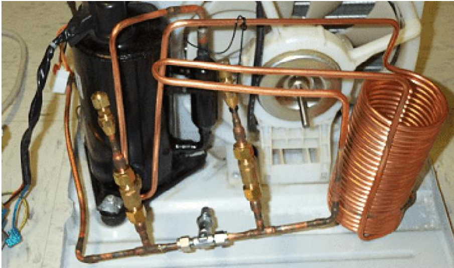
Hình 5.3. Hệ thống lạnh sử dụng ống mao
