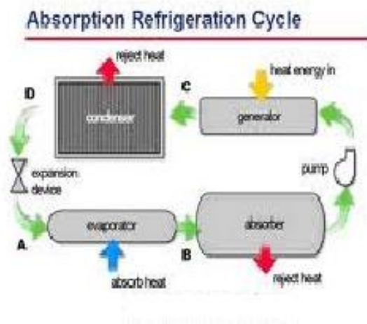
Hình 1.3. Chu trình của máy lạnh hấp thụ
