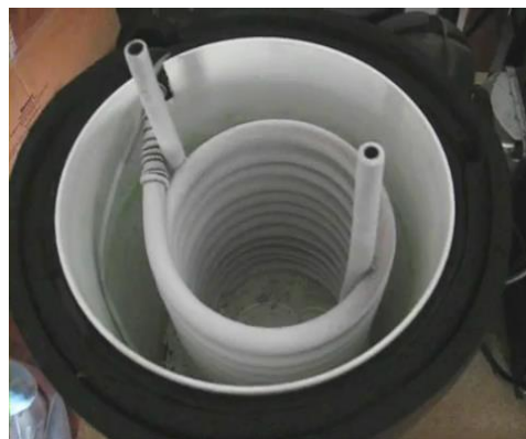
Hình 3.5. Thiết bị ngưng tụ kiểu ống lồng
