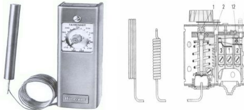
Hình 9.10a. Cấu tạo rơ le nhiệt độ (Thermostat)
