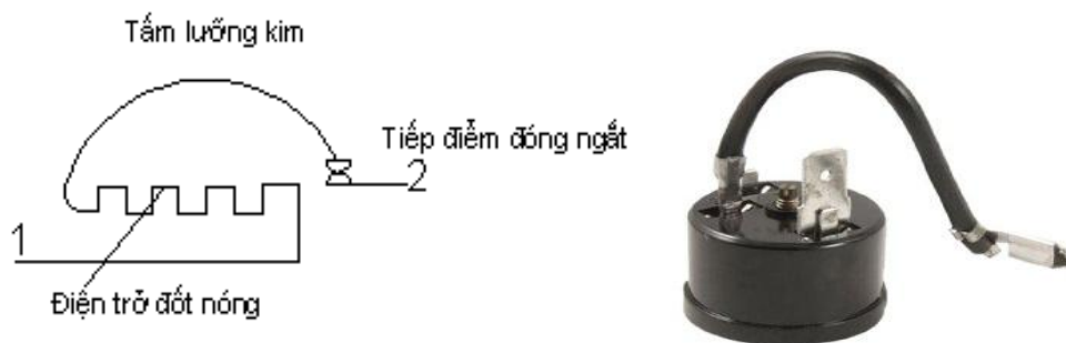
Hình 2.4. Thiết bị bảo vệ quá dòng máy nén kín
