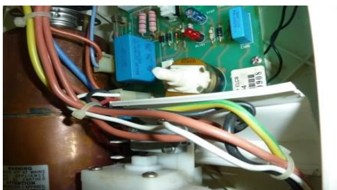
Hình 2.22. Đường dây tiếp đất trong máy giặt.
