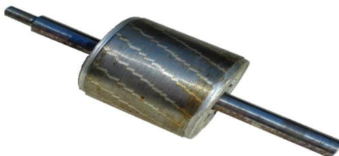
Hình 2.4: Rô to lồng sóc của động cơ KĐB.
