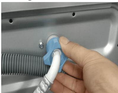
Hình 2.20. Lắp van cấp nước cho máy giặt.
