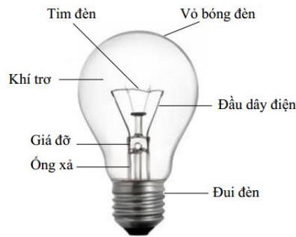
Hình 3.1. Cấu tạo đèn sợi đốt
