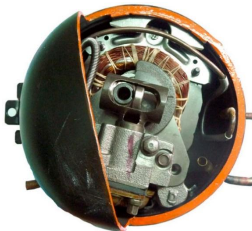
Hình 14.1. Kiểm tra hư hỏng của máy nén
