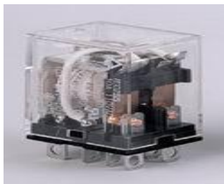
HÌNH DẠNG THỰC TẾ MỘT SỐ LOẠI RƠ LE ĐIỆN TỪ
